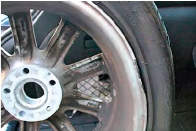
Zware beschadigingen (vervorming) aan de velgen of ontbrekende delen.
