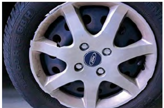
Scheuren in wieldommen of ontbrekende onderdelen van wieldommen.
