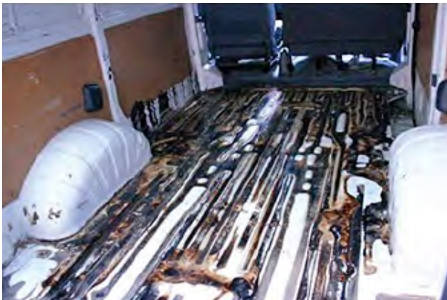
Wanneer door vloeistoffen de laadruimte is aangetast.
