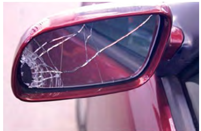
Vervormingen of kapotte spiegels en beschadigingen van meer dan 50mm lang en die door de laklaag heendringen.
