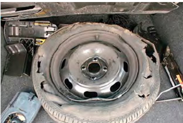
Beschadiging aan de band zoals scheuren, barsten, gaten of banden met onvoldoende luchtdruk als gevolg van een lek.
