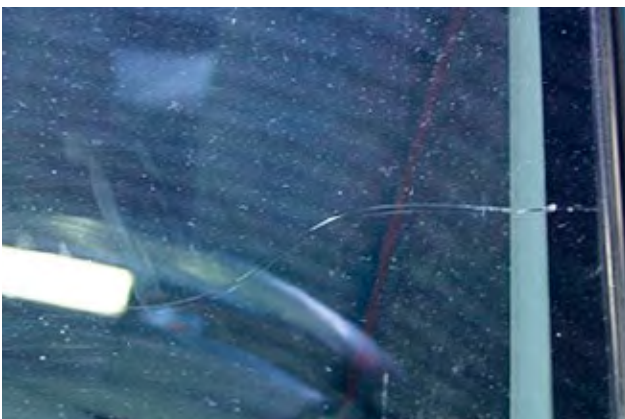
Scheur(en) op ruiten die ontstaan zijn door steenslag.
