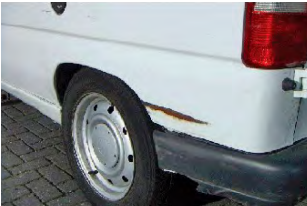
Deuken, butsen of krassen waarbij de laklaag zodanig is beschadigd dat er zichtbare roestplekken ontstaan.
