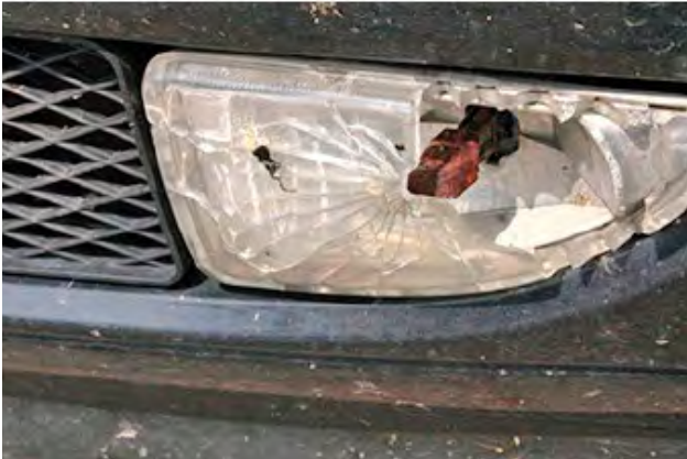
Wanneer het glas van een mistlamp gebroken is.
